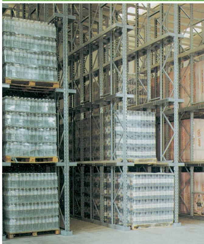
Scaffalature componibili indicate per grandi portate. Costruzione in acciaio. Verniciatura a polvere epossidica ed essiccazione in galleria termica.
