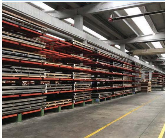
CANTILEVER MONOFRONTE CON TELAIO
